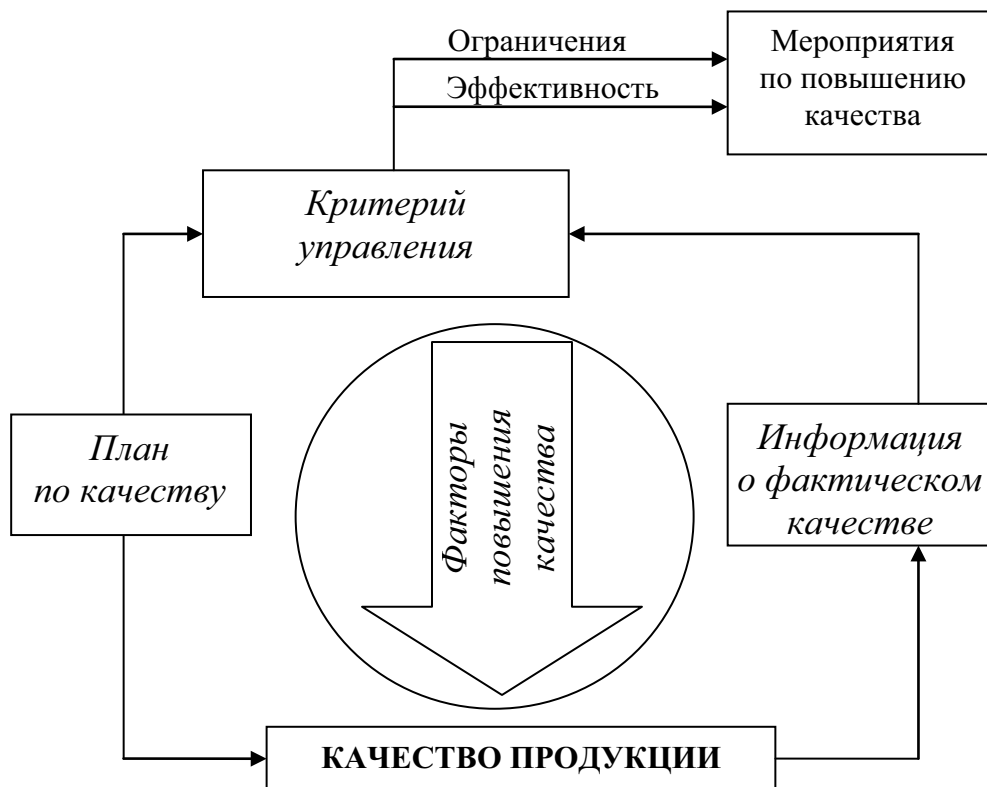
Рис. 2. Содержание процесса управления качеством продукции
