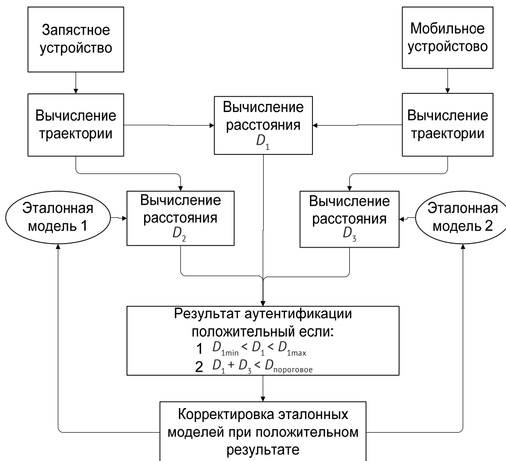
Рис. 3. Алгоритм работы аутентификации, использующей мобильное и запястное устройство одновременно
