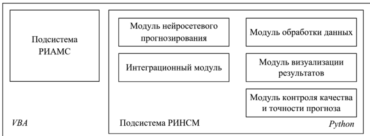
Рис. 6. Функциональная структура гибридной системы прогнозирования
